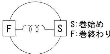
4. 巻線方向 WINDING DIRECTION
