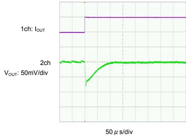
$I_{\text{OUT}}=100\text{mA} \rightarrow 1\text{mA}$
