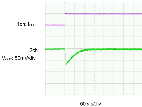
$I_{\text{OUT}}=1\text{mA} \rightarrow 300\text{mA}$
