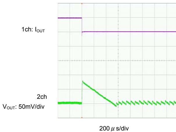
$I_{\text{OUT}}=300\text{mA} \rightarrow 1\text{mA}$
