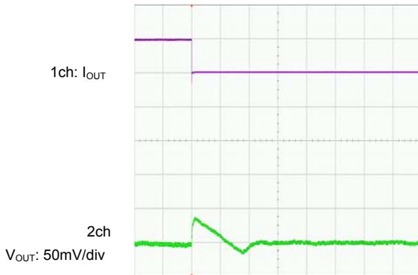
$I_{\text{OUT}}=300\text{mA} \rightarrow 1\text{mA}$
