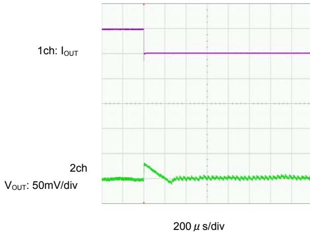
$I_{\text{OUT}}=300\text{mA} \rightarrow 1\text{mA}$
