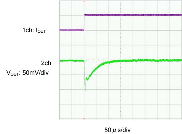
$I_{\text{OUT}}=100\text{mA} \rightarrow 1\text{mA}$
