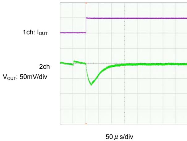
$I_{\text{OUT}}=1\text{mA} \rightarrow 300\text{mA}$
