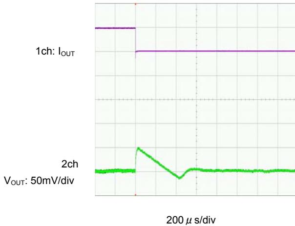
$I_{\text{OUT}}=300\text{mA} \rightarrow 1\text{mA}$
