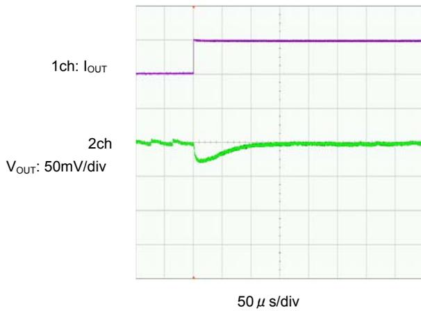
$I_{\text{OUT}}=1\text{mA} \rightarrow 300\text{mA}$
