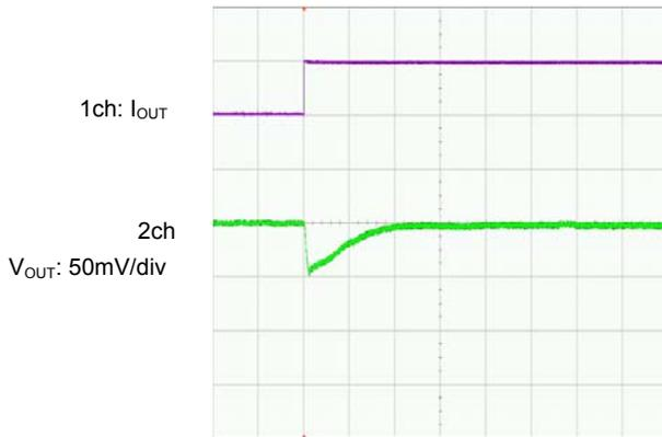
$I_{\text{OUT}}=1\text{mA} \rightarrow 300\text{mA}$
