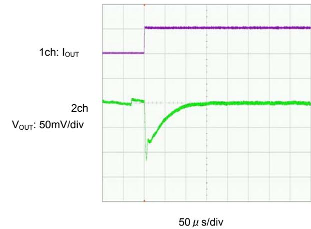
$I_{\text{OUT}}=100\text{mA} \rightarrow 1\text{mA}$
