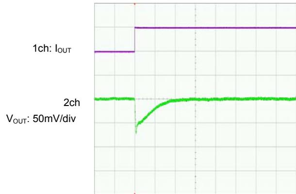
$I_{\text{OUT}}=100\text{mA} \rightarrow 1\text{mA}$
